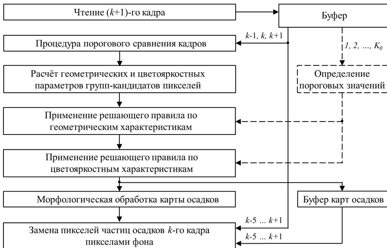
Рисунок 2.16 – Функциональная схема разработанного алгоритма уменьшения видимости частиц осадков
