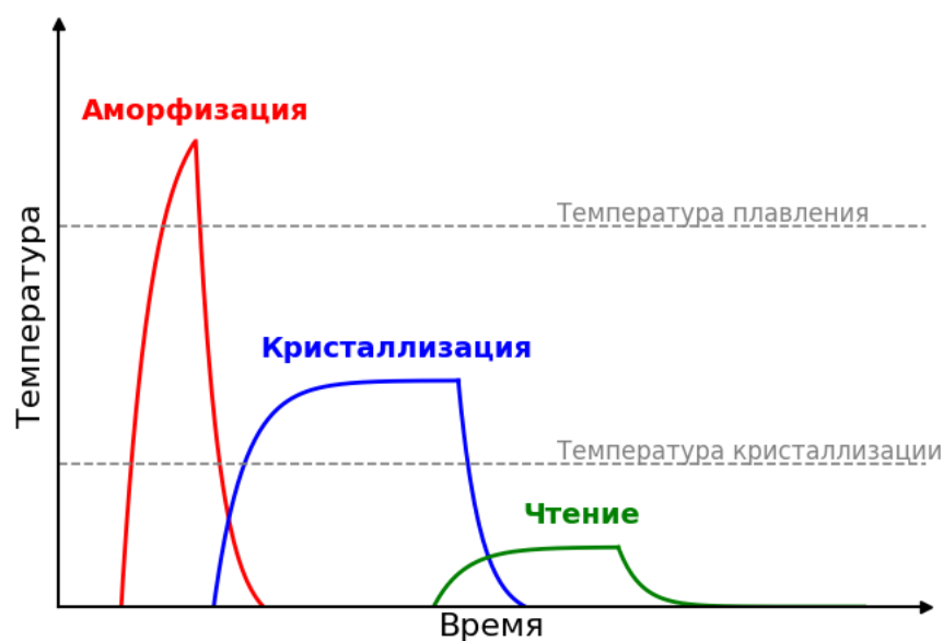
Рисунок 1.1 – Режим работы ячейки фазовой памяти
