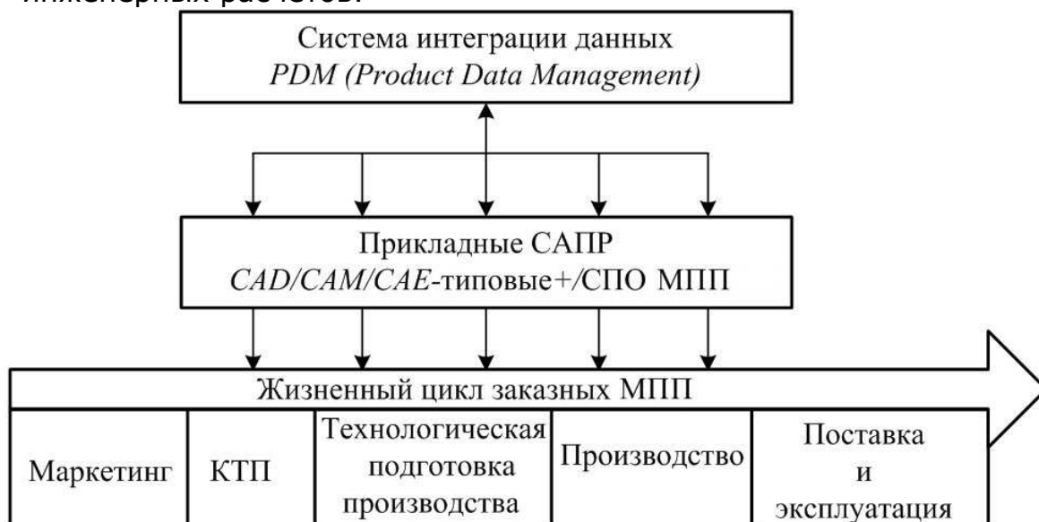
Рис.1. Система интеграции данных по стадиям жизненного цикла производства МПП
