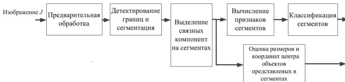
Рис. 1. Структурная схема алгоритма распознавания промышленных дымовых труб на изображении
