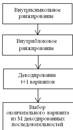
Рис.1. Алгоритм «мягкого» декодирования блочных кодов
