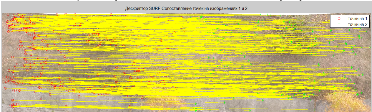
Рис. 3. Полученные пары сопоставленных точек с использованием дескриптора SURF
