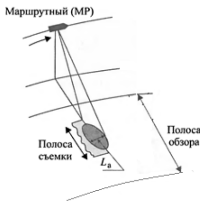
Рис. 1 – Геометрия съемки в маршрутном режиме обзора
