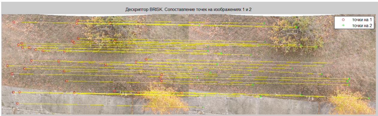
Рис. 2. Полученные пары сопоставленных точек с использованием дескриптора BRISK
