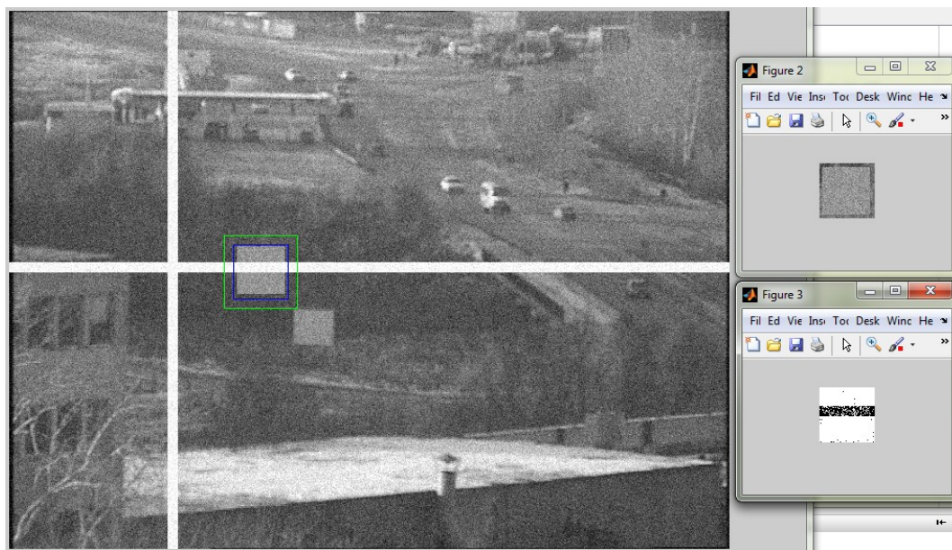
Рис. 2. Пример работы алгоритма для случая заслонения 20% точек объекта и значении порога 87
