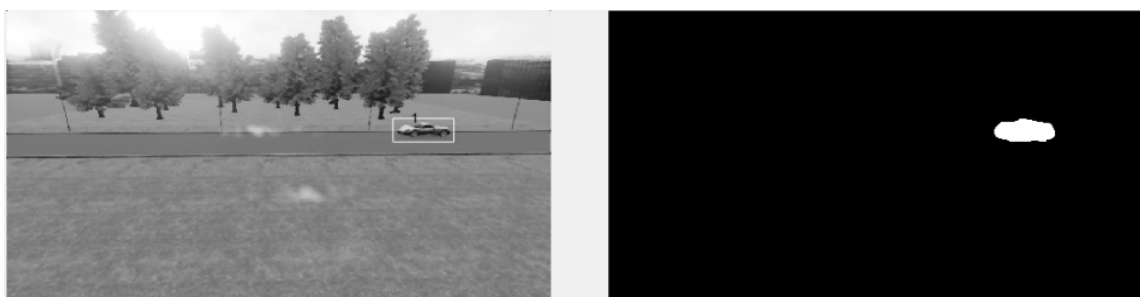
Рис. 7. Пример работы алгоритма адаптивной пороговой обработки
