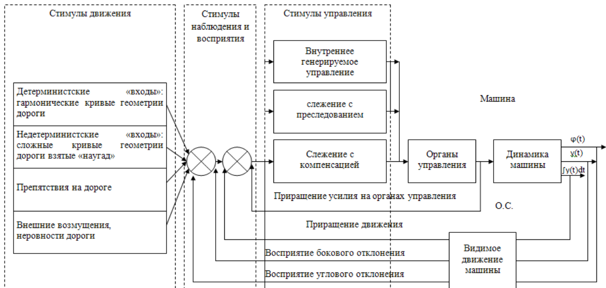
Рис. 1. Структурная схема системы В-М-Д в качестве образно-понятийной модели деятельности водителя
