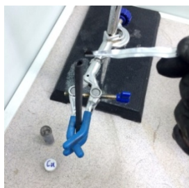
Рис. 1. Этап подготовки композитного электрода для синтеза металлофуллеренов
