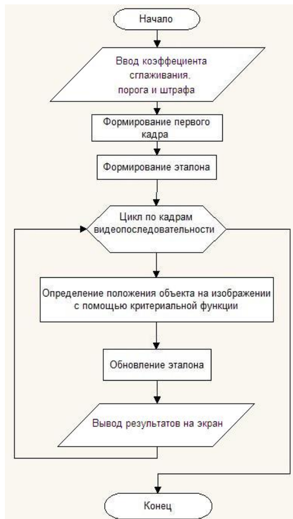
Рис. 1. Блок-схема модифицированного корреляционно-экстремального алгоритма
