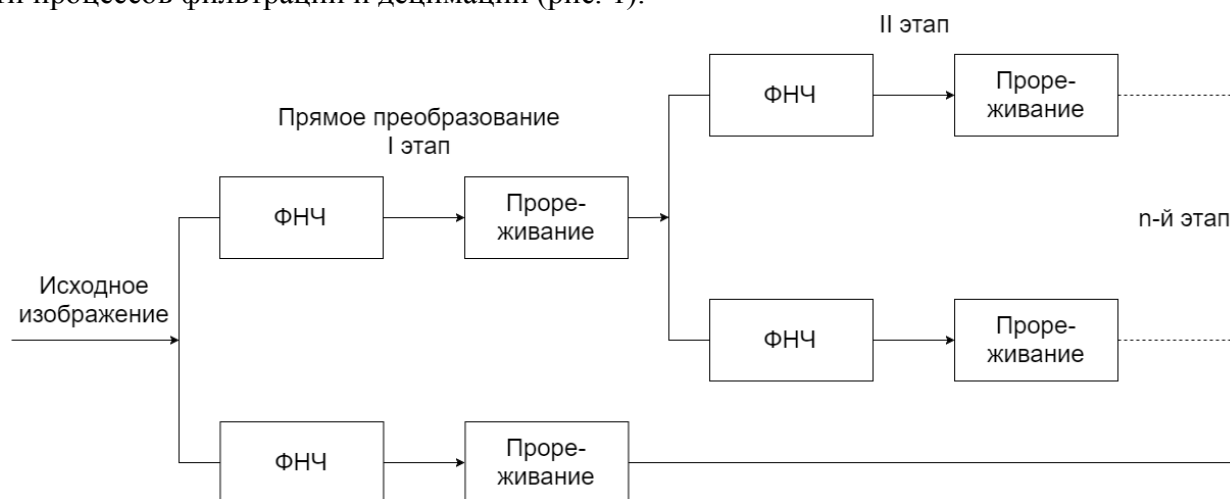
Рис. 1. Схема дискретного вейвлет-преобразования
