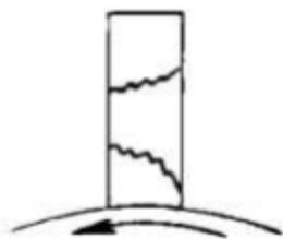
Рис.5 Трещина щетки в результате колебаний [5].
