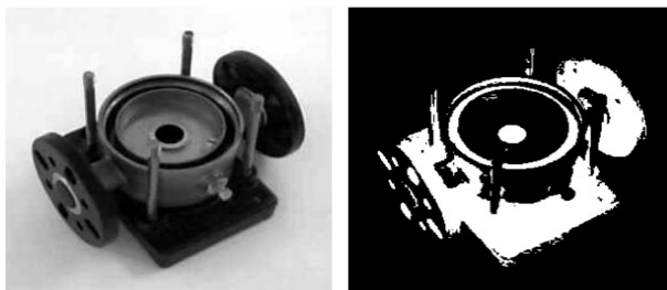
Рис. 1. Пример бинаризация с нижним порогом
