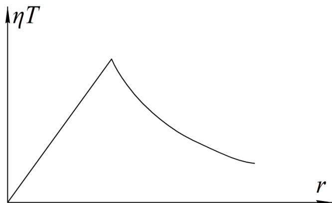
Рис. 3. Зависимость степени устойчивости \eta от расстояния r , аналогичная зависимости напряженности поля тяготения от расстояния до центра притяжения масс
