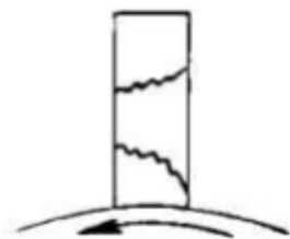
Рис. 5. Трещина щетки в результате колебаний [5]
