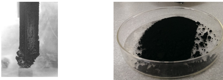
Рис. 2. Депозит и сажа сформировавшиеся на композитном электроде графит/Al в результате дугового разряда
