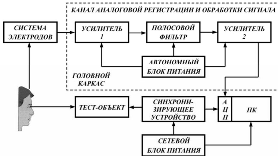
Рис. 8. Структурная схема аппаратного средства диагностики цилиарной мышцы
