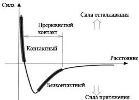
Рисунок 2 – Кривая зависимости межатомной силы от расстояния
