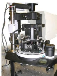
**Рисунок 12 – Объединенные АСМ, оптический микроскоп и 3D конфокальный Рамановский микроскоп**
