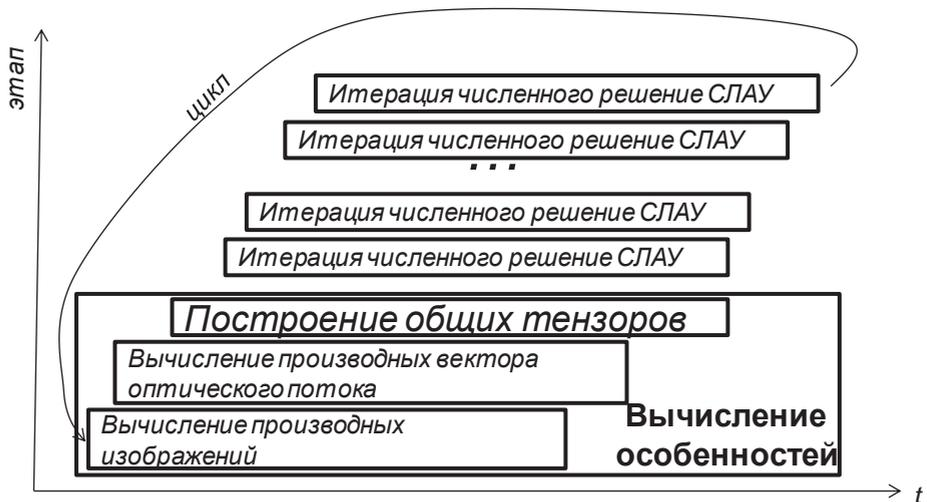
Рисунок 1 - Функциональная схема аппаратной организации вычисления оптического потока
