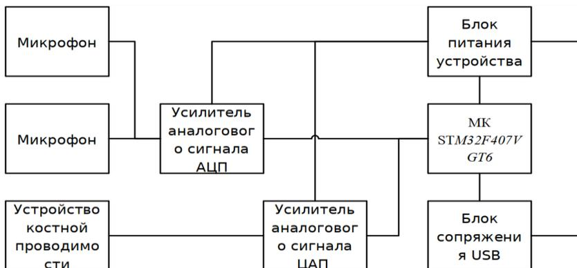
Рисунок 1 – Структурная схема мобильного измерительного устройства
