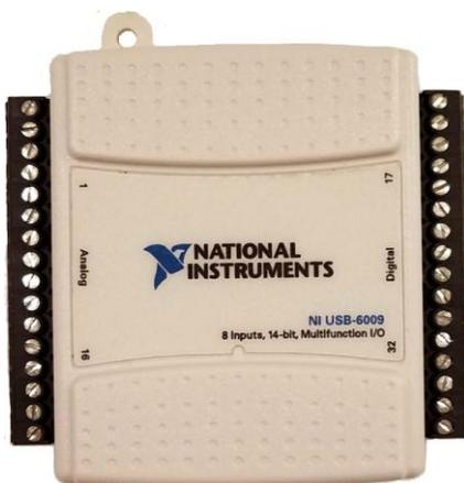
Рисунок 2 – Модуль сбора данных для ПК
