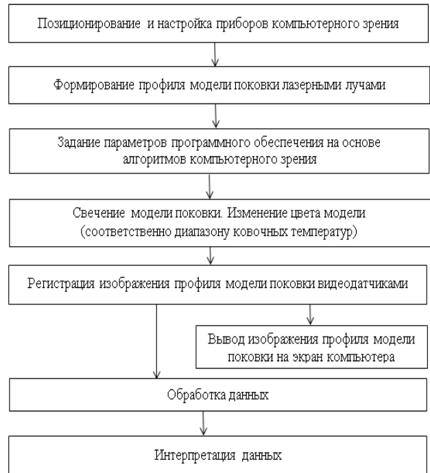
Рисунок 4 – Структура методики моделирования воздействия физических факторов процесса ковки на формирование изображения поковки
