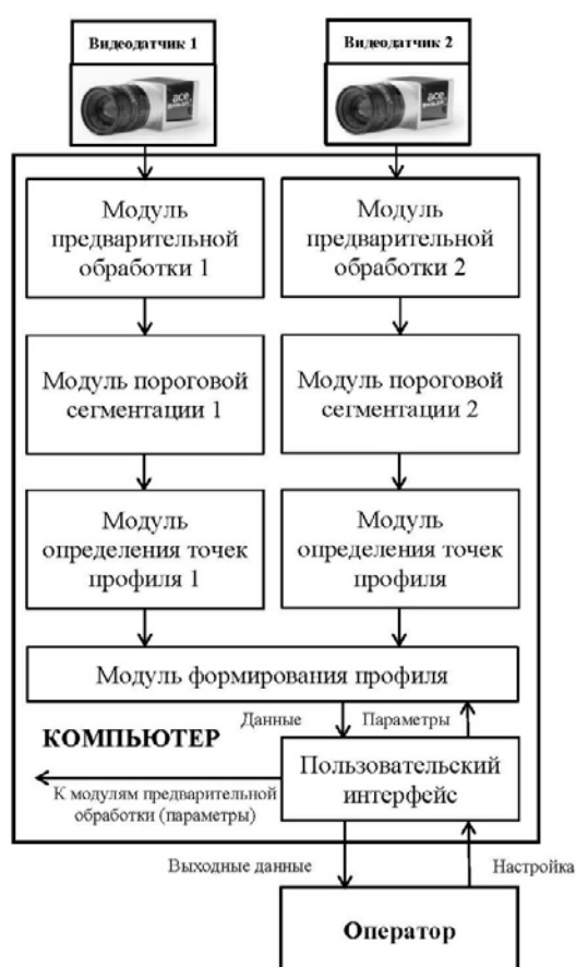
Рисунок 14 – Структурная схема программного обеспечения экспериментальной установки
