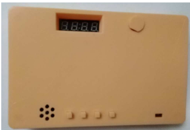
Рис. 5. Корпус для платы, представленной на рисунке 1.
