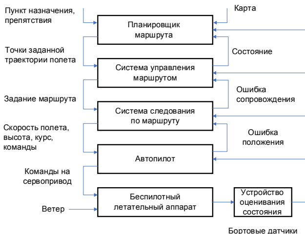
Рис. 1. Программная архитектура системы управления БЛА
