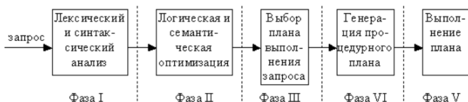
Рис. 1. Последовательность выполнения запросов в реляционных СУБД
