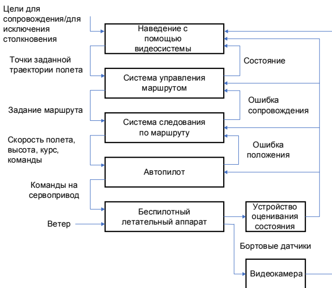
Рис. 2. Архитектура, включающая видеосистему
