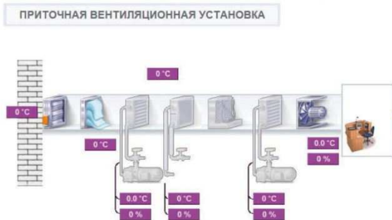
Рис. 2. Программная реализация системы автоматизации.
