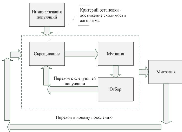
Рис. 2. Обобщенная схема островной модели генетического алгоритма
