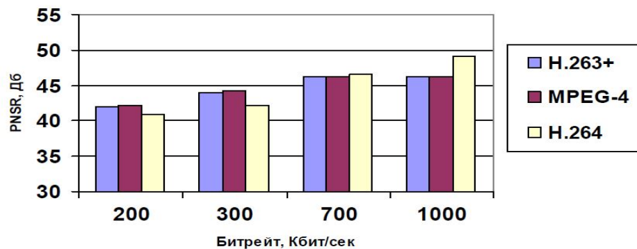
Рис. 5. Зависимость качества передачи яркости от битрейта третьего фрагмента
