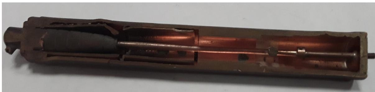
Рис. 1. Внешний вид режекторного фильтра
