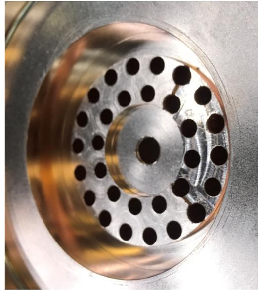
б) фрезеровка в реальном приборе
