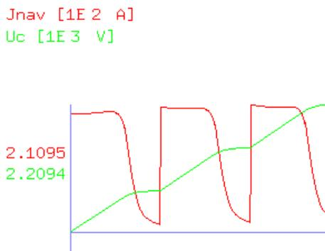
Рис. 6. Зависимость наведенного тока и напряжения на емкости коллектора
