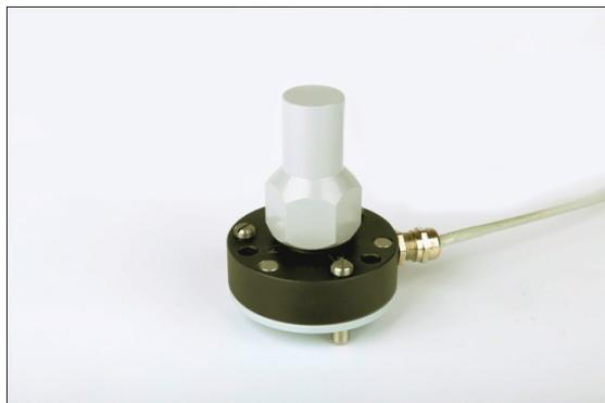
Рис. 2. Инклинометр ИН-Д2
