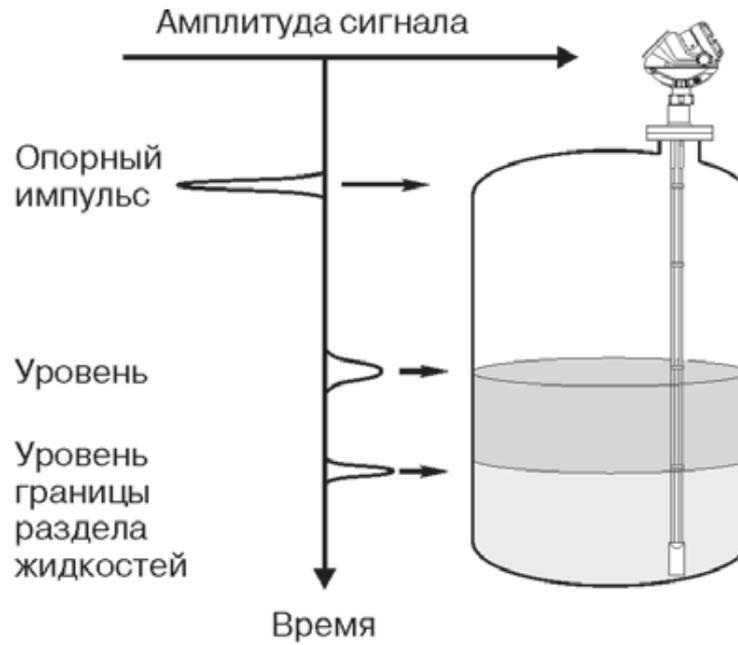
Рис. 2. Схема установки уровнемера
