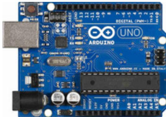
Рис. 1. Микропроцессорная плата Arduino UNO
