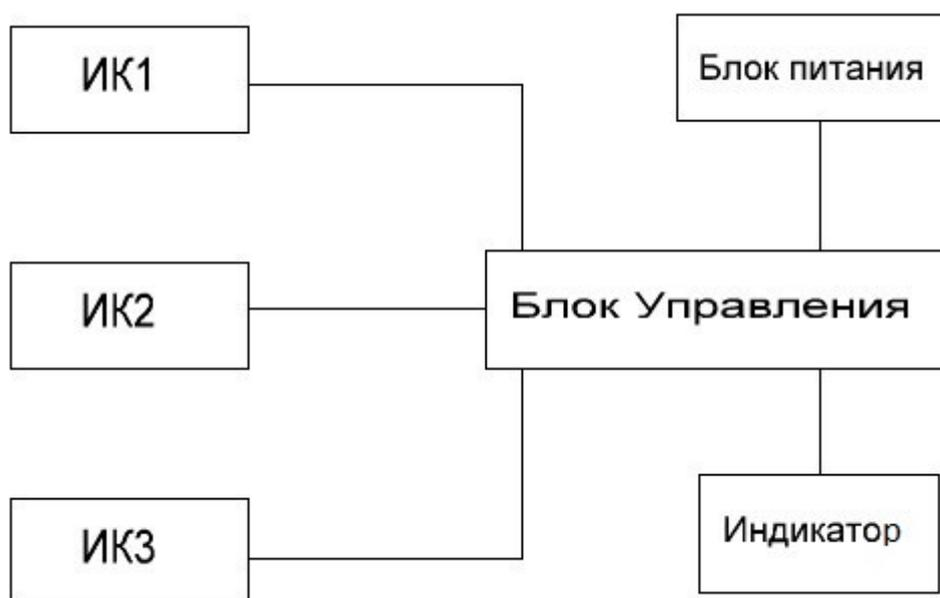
Рис. 3. Структурная схема 3-х канального ультразвукового уровнемера
