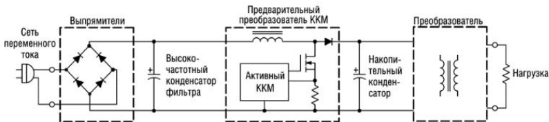
Рисунок 3 – Схема активного контроллера ККМ между входным выпрямителем и накопительным конденсатором.
