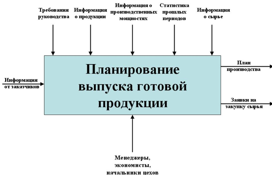
Рис. 1. Диаграмма верхнего уровня функциональной модели процесса планирования выпуска готовой продукции
