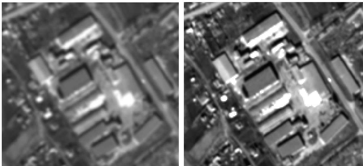
Рис. 2. Алгебраическое комплексирование видеоданных от КА «Ресурс-П» (слева - снимок от одной ПЗС-линейки, справа - результат комплексирования данных от трех линеек)
