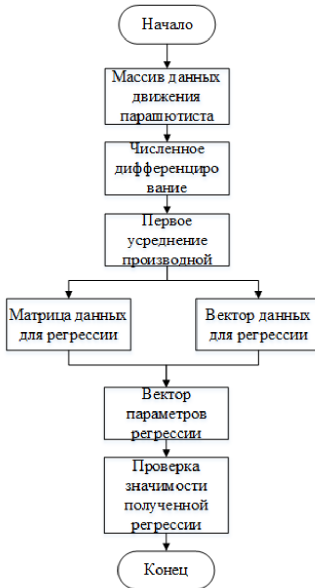
Рисунок 3 – Алгоритм работы программного модуля «Построение линейной системы уравнений, описывающей траекторию движения парашютиста»
