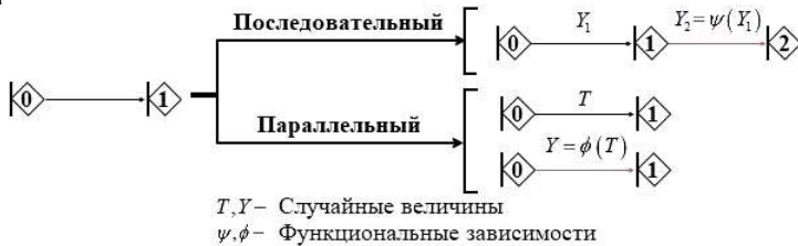
Рисунок 1 – Последовательный и параллельный подходы применения функциональной зависимости к сетевой модели
