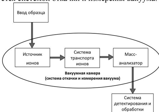
Рисунок 1 – Блок-схема масс-спектрометра
