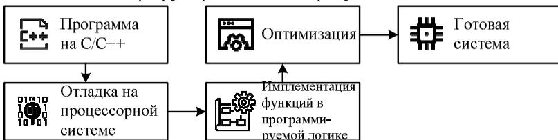
Рисунок 5 – Высокоуровневое проектирование для СнК
