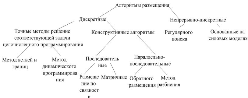
Рисунок 1 – Классификация алгоритмов размещения
