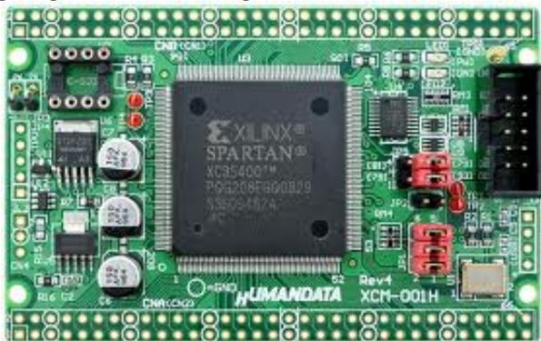
Рисунок 1 – ПЛИС Spartan-3 фирмы Xilinx
