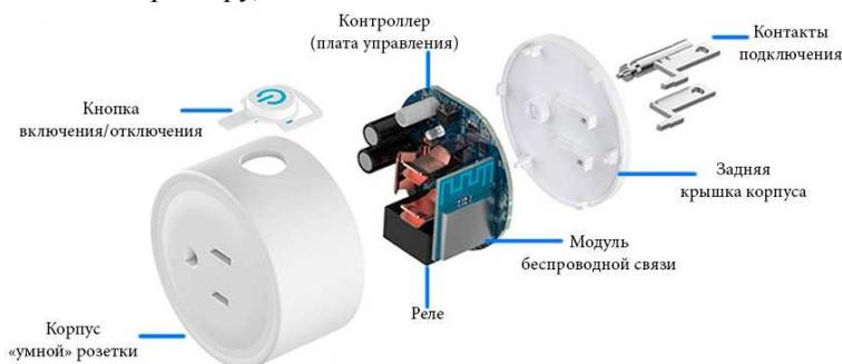
Рисунок 1 – Принципиальная схема «Умной розетки»
