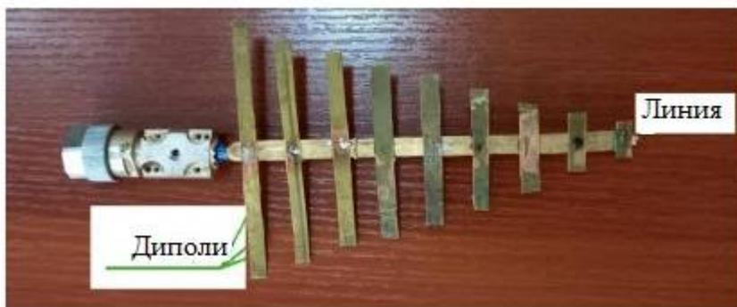
Рис. 3. Общий вид разработанной логопериодической антенны с улучшенными техническими параметрами
