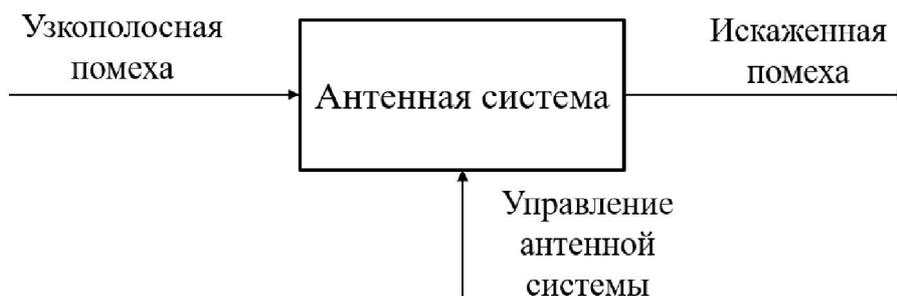
Рис. 1. Структурная схема преобразования узкополосной помехи
