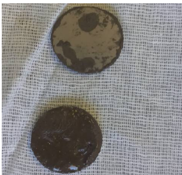
Рис. 3. Анод, склеенный с помощью ФТК-ВК-2 из молибдена и АПГ
