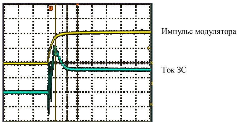
Рис. 3. Импульс модулятора и ток ЗС во время включения ЛБВ
