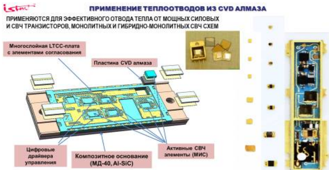
Рис. 7. Применение теплоотводов из CVD алмаза
