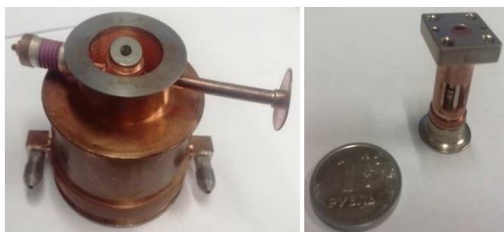
Рис. 8. Основные узлы разрабатываемой ЛБВ: а) анодный блок, б) электронная пушка, в) коллектор, г) вывод энергии
