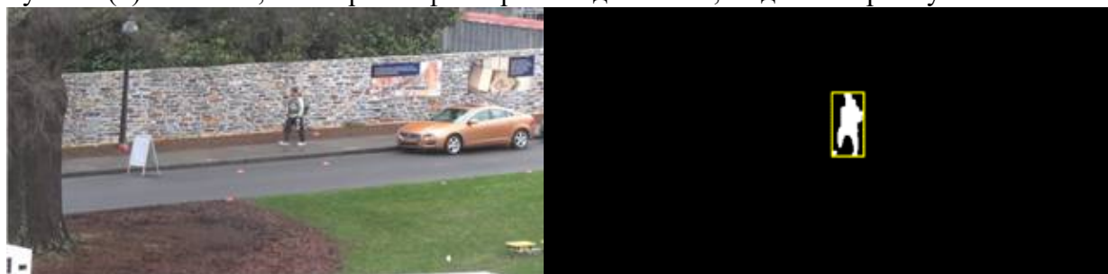
а б Рис. 1. Пример выделения объекта по признаку движения: а - исходное изображение, б – результирующее бинарное изображение
