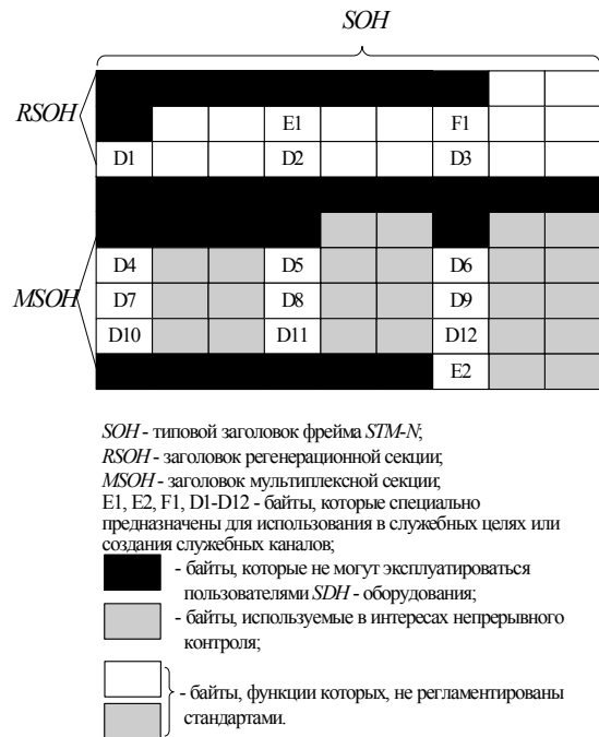
Рисунок 2 – Вариант размещения байт контрольной комбинации в заголовке мультиплексной секции STM-N
