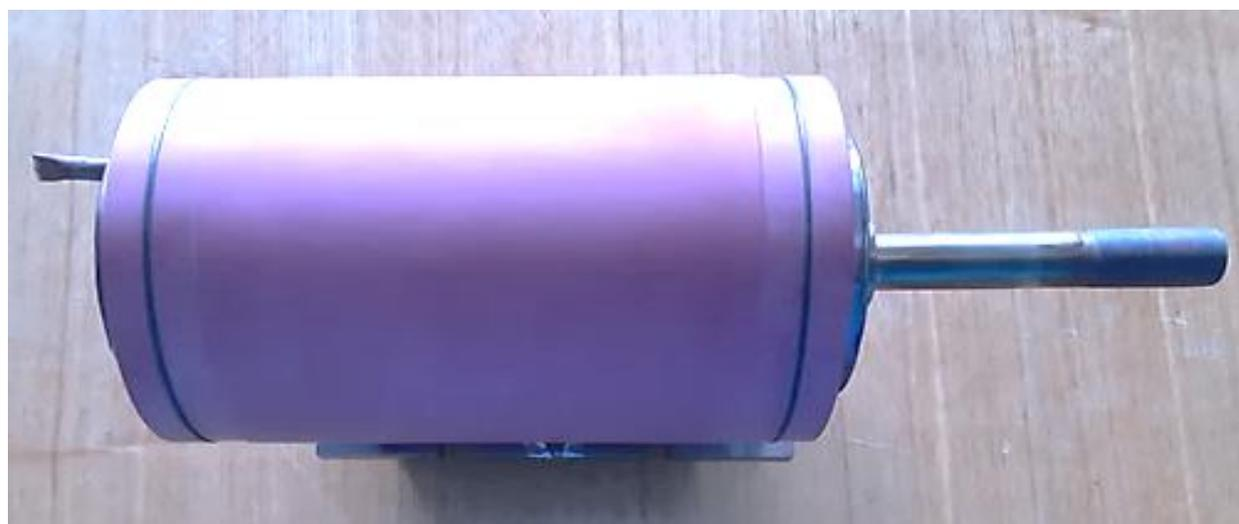
**Рисунок 9 – Фотография экспериментального образца микрофокусной рентгеновской трубки повышенной мощности**
