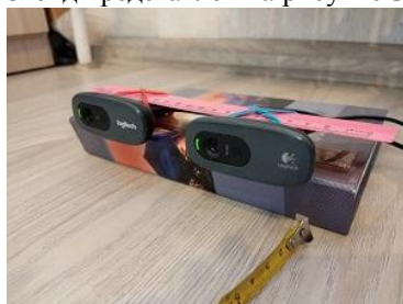
Рисунок 3 – Стенд со скрепленными камерами
