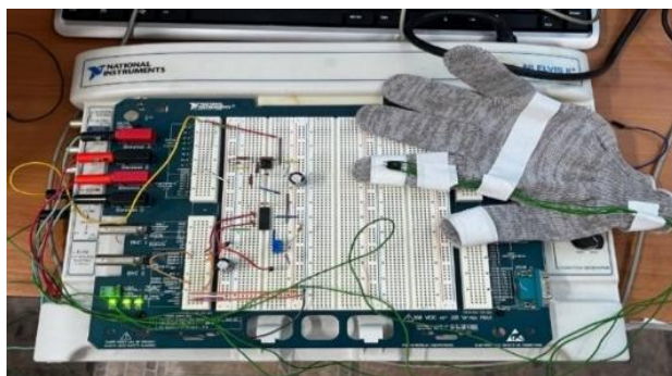
Рис. 1 – Экспериментальная установка по исследованию макетного образца тактильного канала бионического протеза кисти руки
