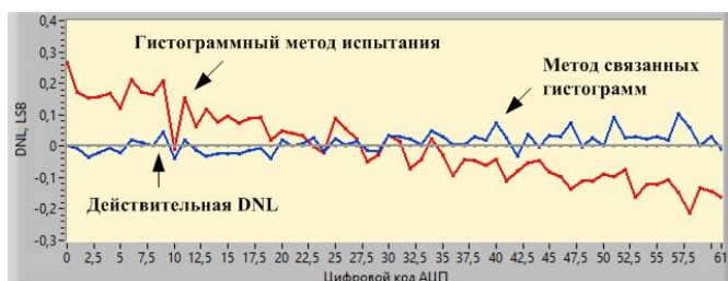
а) График зависимости DNL от текущего кода 6 разрядного АЦП
