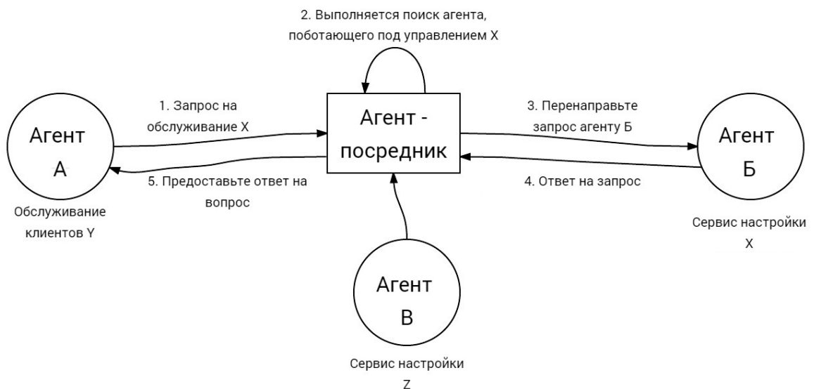
Рис. 12. Вариант исполнения Координатора
