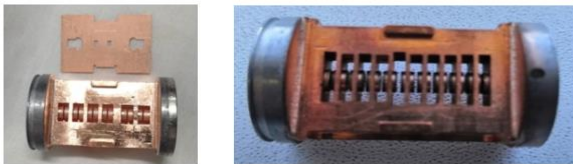
Рисунок 8 – 6-ти и 10-ти резонаторные системы исследуемых моделей НМЛК
