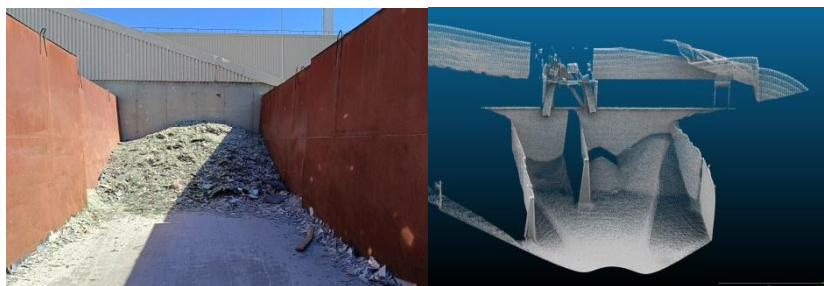
Рис. 2 – Пример создания облака точек складского помещения мобильной системой
