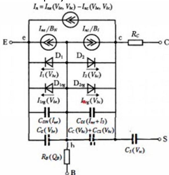
Эквивалентная схема транзистора на основе модели Гуммеля-Пуна
