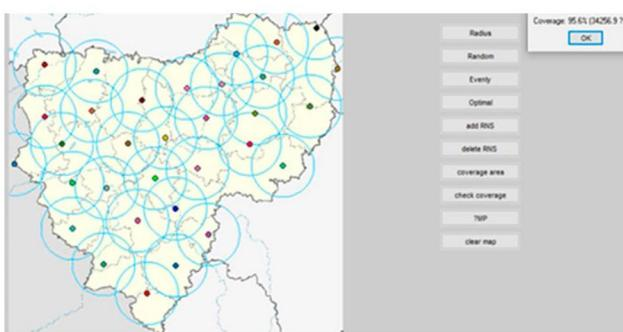
Схема оптимального покрытия РНС-области
