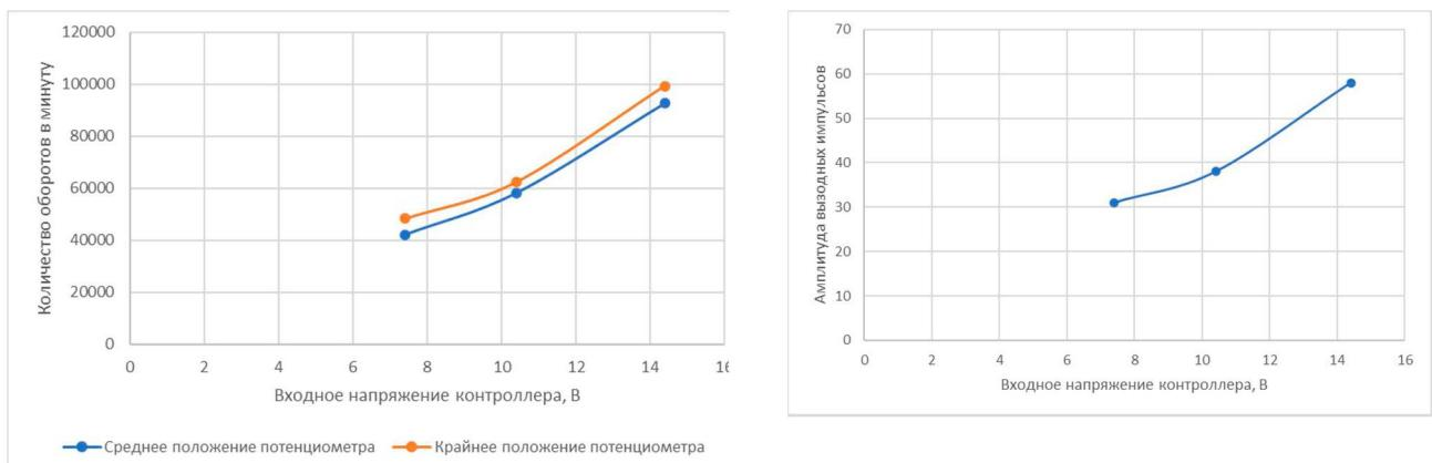
**Зависимости количества оборотов в минуту и амплитуды выходных импульсов от входного напряжения**
