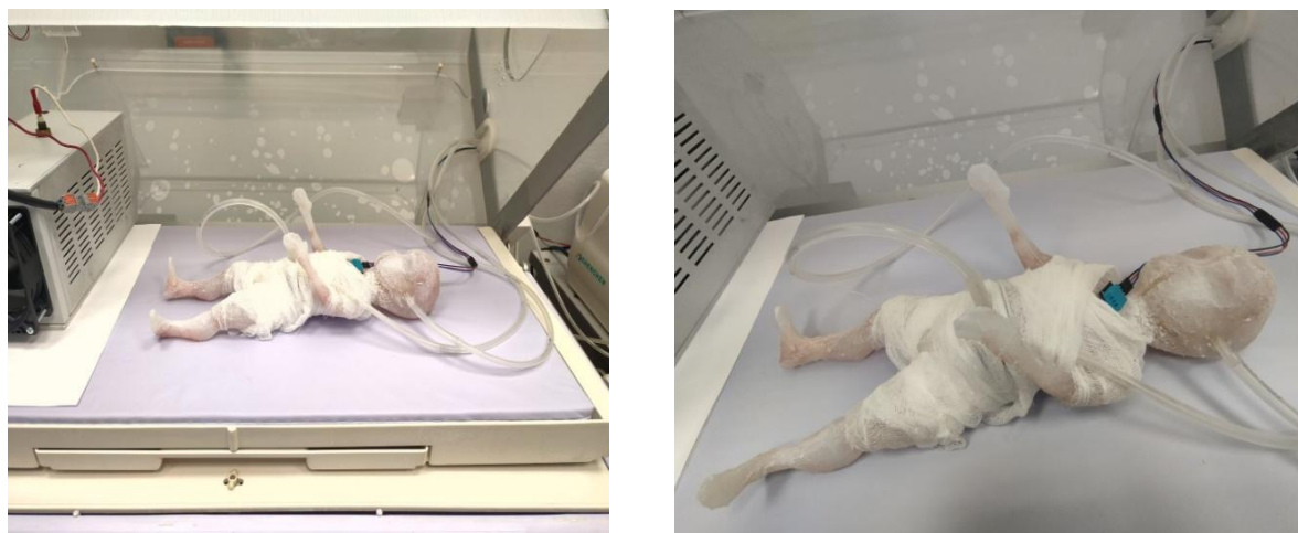
Рисунок 2.17 – Полноростовой гидродинамический фантом тела новорождённого
