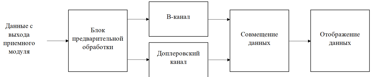
Рисунок 4 – Укрупненная структурная схема имитационной модели ультразвукового медицинского диагностического устройства
