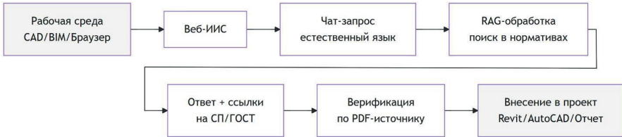
Рисунок 1 – Процессная модель взаимодействия проектировщика с ИИС
