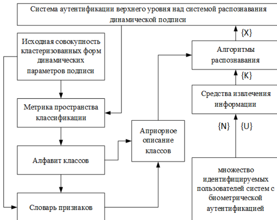
Рисунок 3.1 – Общая схема применения алгоритмов классификации динамической подписи
