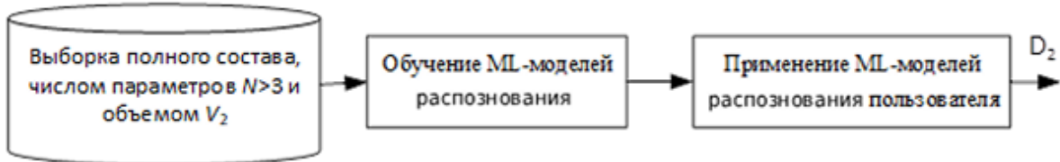
Рисунок 2.2 – Последовательность создания модели классификации с использованием выборки полного состава и малого объема
