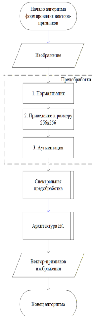
Рисунок 5 – Схема алгоритма формирования вектора-признаков изображения
