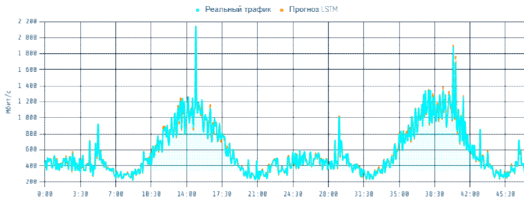
Рис.1. Сравнение фактических и прогнозируемых значений сетевого трафика на протяжении 48 часов
