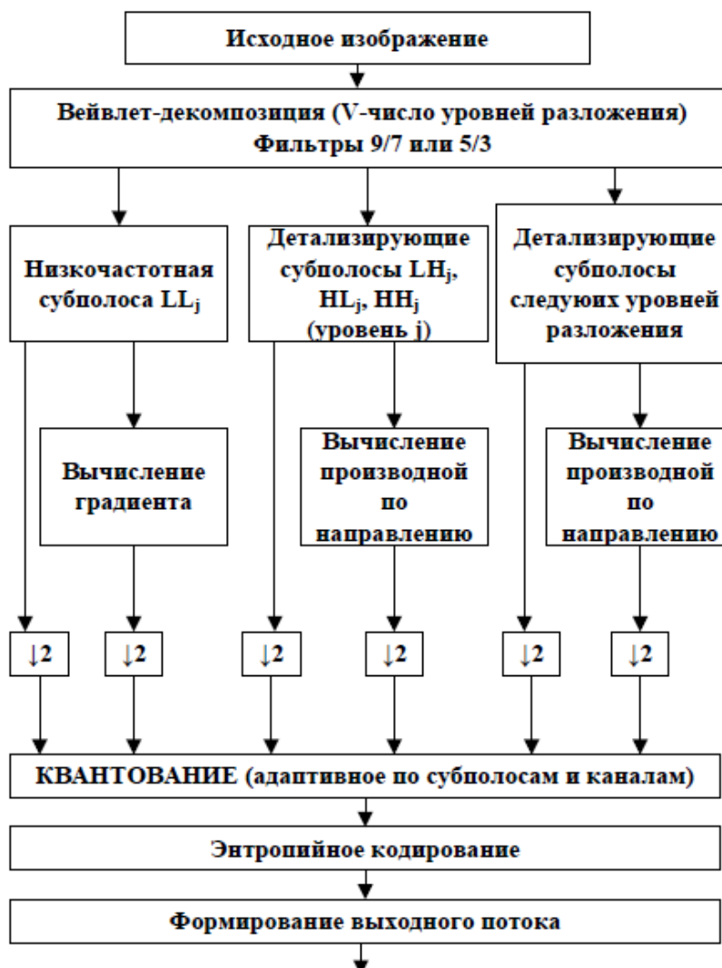
Рис. 1. Структурная схема гибридного кодера (↓2 – децимация в 2 раза)
