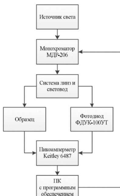
Рис. 2. Схема измерительной установки по определению квантового выхода ФЭП [1]
