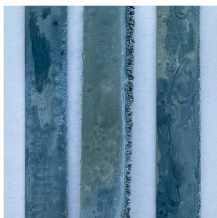
Рис. 3. Изменённые под воздействием раствора хлорида натрия цинковые покрытия первой, второй и третьей пластины соответственно
