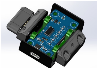
Рис. 7. 3D-модель крепления платы внутри корпуса
