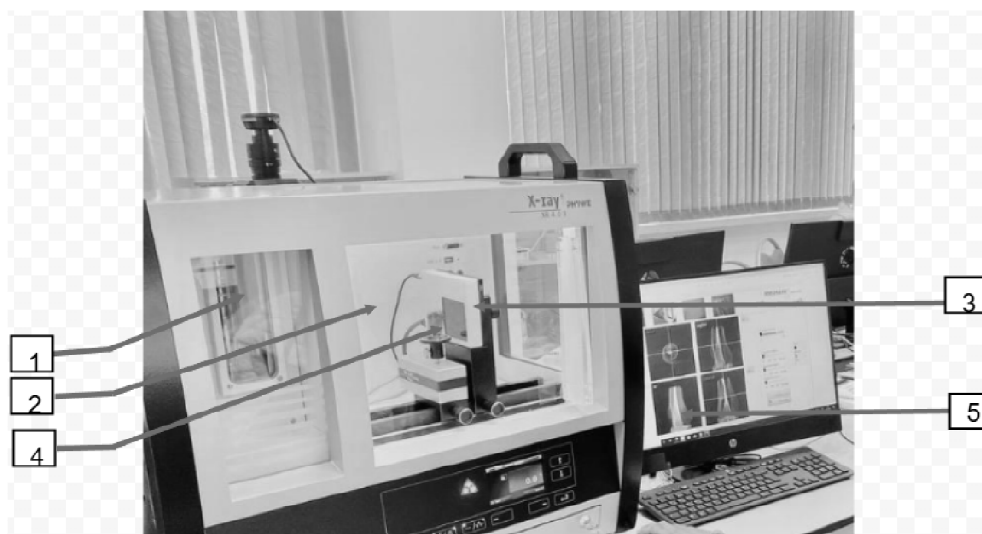
Рис. 1. Лабораторный стенд на базе компьютерного рентгеновского томографа XR 4.0: 1 – рентгеновская трубка; 2 – экспериментальная камера; 3 – цифровая камера; 4 – поворотный столик с исследуемым образцом; 5 – компьютер с программным обеспечением реконструкции КТ изображений
