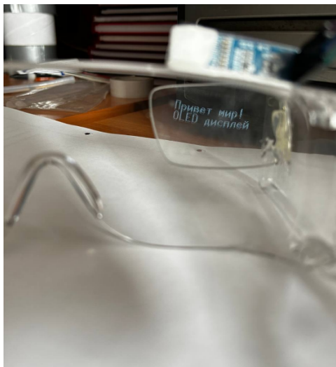
Рис. 1. Прототип умных очков для инвалидов по слуху
