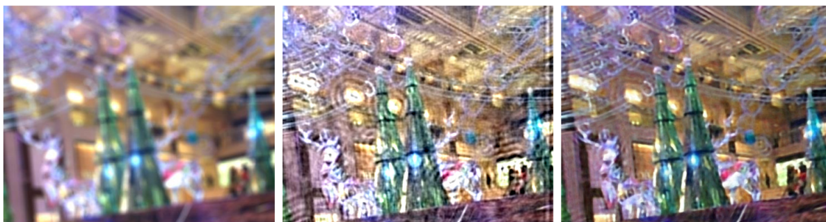
Рис. 1. Исходное расфокусированное изображение (слева), результат Винеровской фильтрации (в центре) и результат нейросетевого алгоритма (справа)
