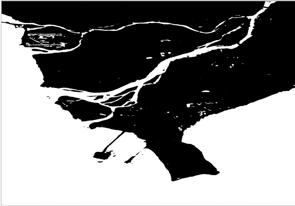
Рисунок 32 – Результат сегментации изображения №1 с помощью второго варианта алгоритма комплексирования на основе признака гомогенности
