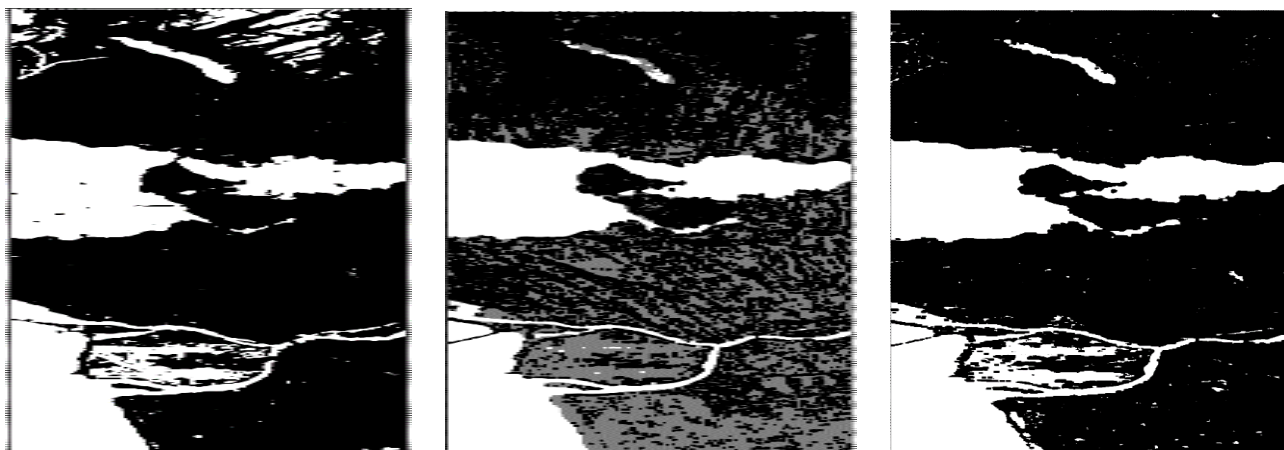
Рисунок 49 – Пример применения маски классов поверхности для уточнения результатов сегментации (слева – результат сегментации с помощью АС изображения с поляризацией HH по признаку гомогенности, по центру – сформированная маска классов поверхности, справа – результат комплексирования)
