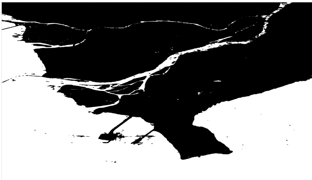
Рисунок 21 – Результат сегментации изображения №1 на основе поляриметрической классификации Клода-Потье с использованием классификатора Уишарта
