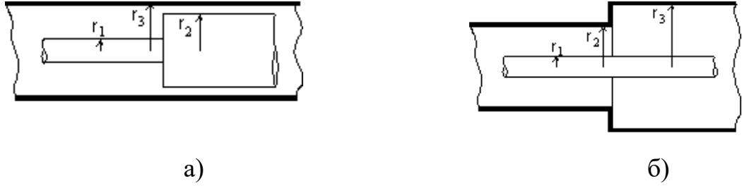
Рисунок 2.4 – Неоднородности коаксиальной линии
