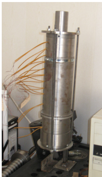
Рисунок 3 – Внешний вид опытного образца трубчатого ЛЭД
