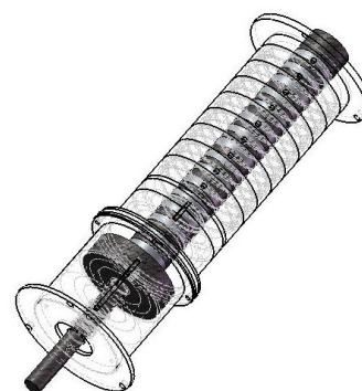
Рисунок 2 – Конструкция статора и ротора трубчатого ЛЭД
