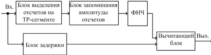
Рис. 1 – Структурная схема устройства устранения дрейфа изолинии
