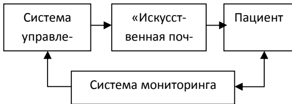
Рис.1 - Замкнутая биотехническая система регулирования процессом гемодиализа
