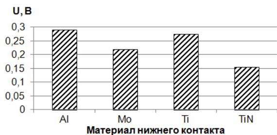
**Рисунок 10** – Величина поверхностного потенциала  $U$  для образцов толщиной 200 нм с разным материалом контактного слоя
