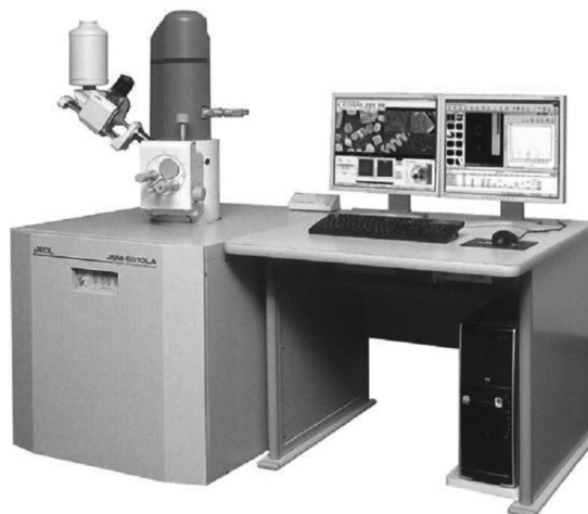
Рисунок 2 – Растровый электронный микроскоп JSM 6610 LV с энергодисперсионным микроанализатором
