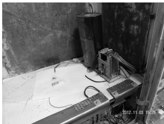
Рисунок 3 – Внешний вид испытательной камеры с установленным в ней газоразрядным стендом
