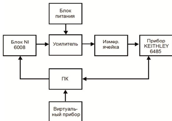
Рисунок 1 – Структурная схема стенда, реализующего метод ВАХ
