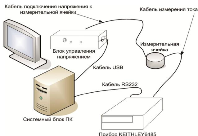
Рисунок 3 – Схема подключения приборов в стенде, реализующем метод ВАХ
