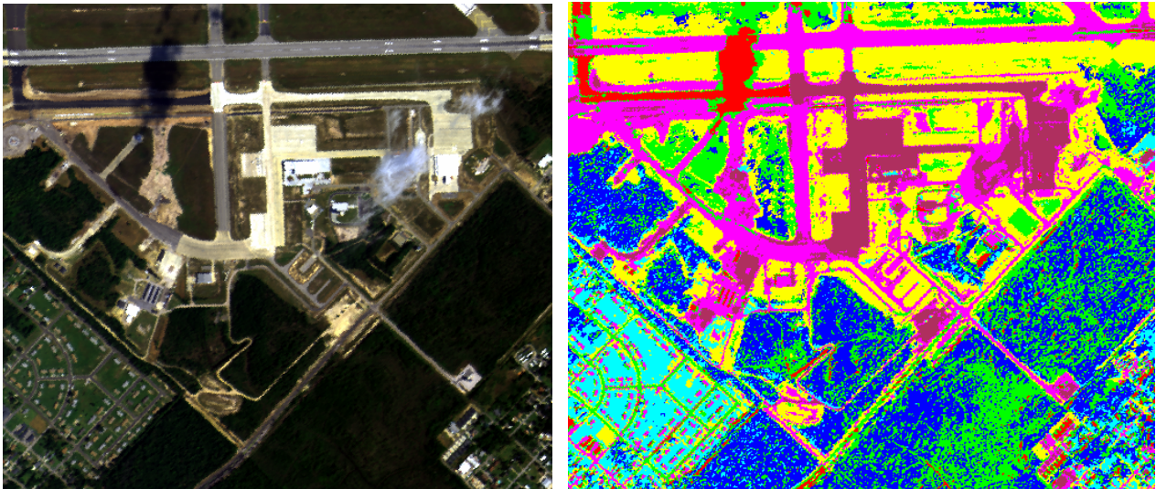
Рис. 1. Пример сегментации объектов на ГСИ с использованием сочетания FCM-алгоритма и генетического алгоритма
